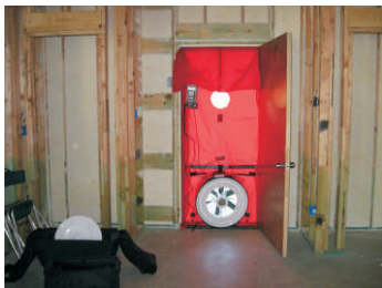
Blower door test
